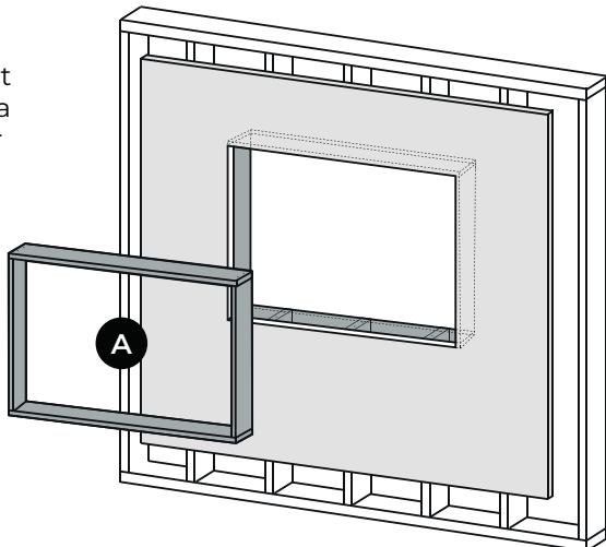
Nous recommandons l'utilisation d'une membrane autocollante à l'intérieur du cadre, dépassant de 1/4", afin d'imperméabiliser l'ouverture.
