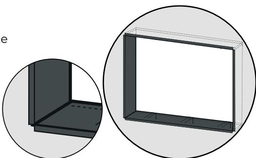
Après avoir appliqué la membrane tel qu'indiqué à l'étape précédente, appliquez une quantité généreuse de silicone à polymérisation neutre (non acétique) sur le mur, le long des côtés du support mural et autour des bords et des côtés de la partie encastrée de la niche afin de garantir un joint solide et étanche.
