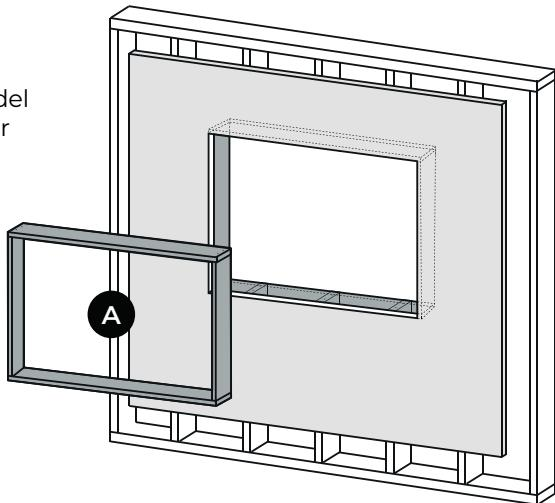
Recomendamos usar una membrana autoadhesiva en el dentro del marco, sobresaliendo 1/4", para impermeabilizar la apertura.
